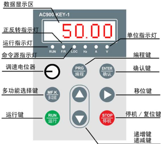
图 2-1 操作面板示意图
